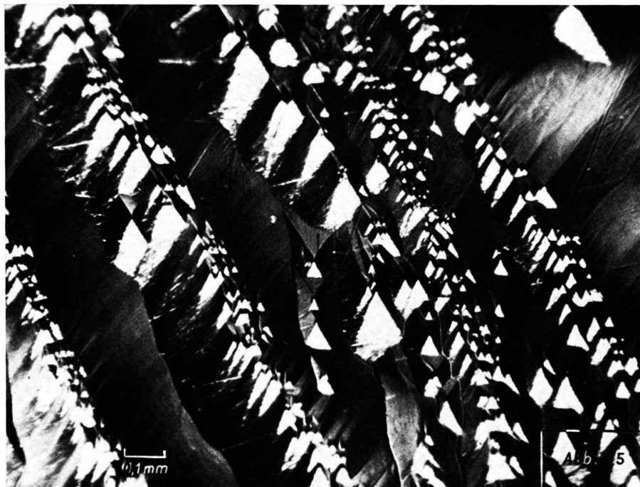
Abb. 5. Charakteristische Ätzpit-Anordnungen auf c -Flächen.
